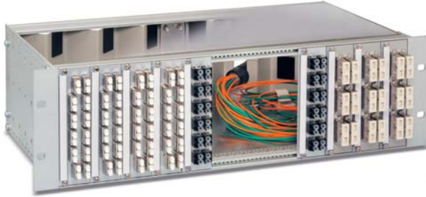
19" 3 HE Verteil-Baugruppenträger mit Patchfeld-Teilfrontplatten und „Z-Blech-Rückwand“ für die Aufnahme von bis zu 12 OSI PRECONNECT® HDCS-G1-Trunks mit Patchfeld-Stecksystemen. Details siehe Seite 100.
